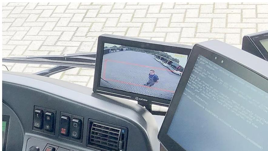
Auf dem Parkplatz von „Reiter's Reisen“ wird demonstriert, wie der Abbiegeassistent funktioniert. Selbst im Stehen wird beim Blinken nach rechts das Kamerabild übertragen, ein Piepen ertönt, wenn jemand in das Feld rechts neben dem Bus läuft.
